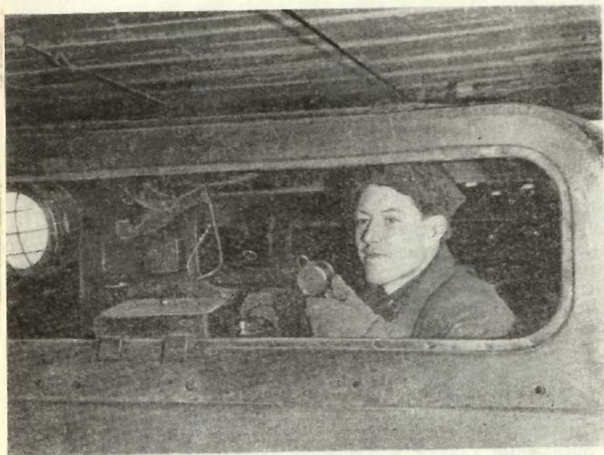
Не выходя из кабины, машинист подземного электровоза разговаривает с диспетчером шахты.
